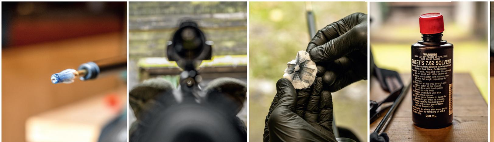
Die Laufablagerungen der alten Laborierung werden durch ein chemisches Solvens (Lösungsmittel, Anm.) aufgelöst. Dazu muss man aber wissen, dass nur Kupfer oder kupferähnliche Metalle mit einem solchen Solvens aufgelöst werden können. Sollte keine chemische Reinigung erfolgen, könnte es sein, dass die neue Laborierung durch die Kupferablagerungen im Lauf keine zufriedenstellende Schussleistung bringt.
